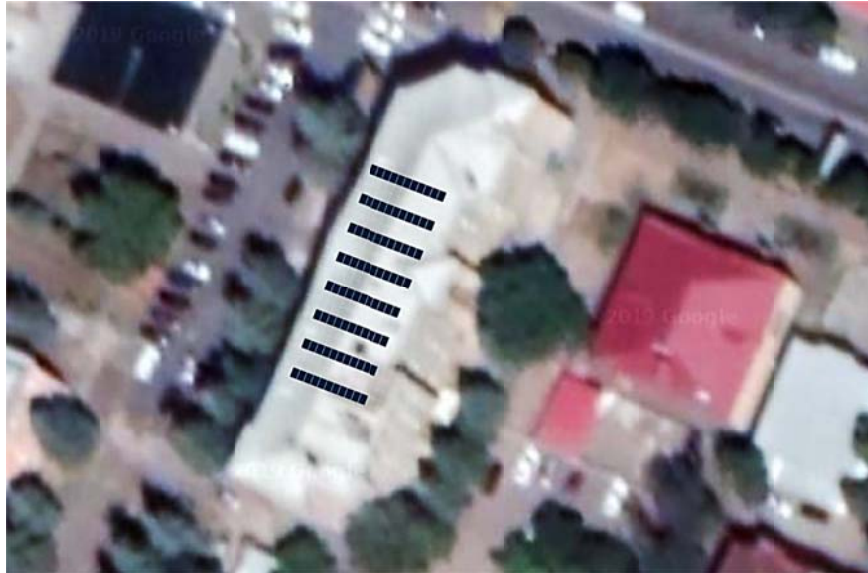
ՖՎ մոդուլների տեղաբաշխումը շենքի տանիքի վրա
